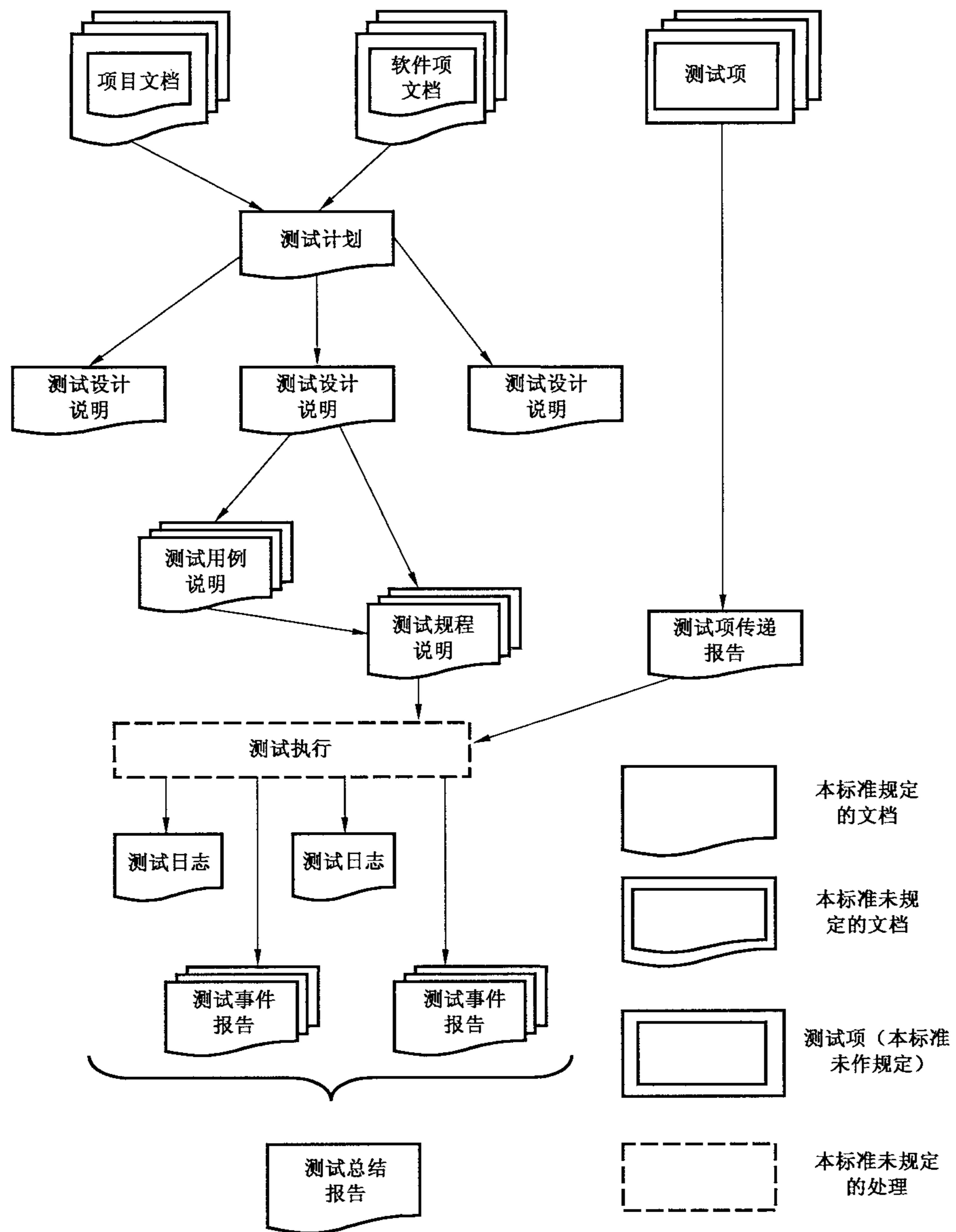
图 1 测试文档与测试过程的关系
